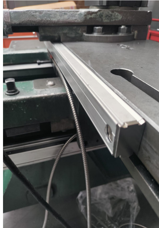
Imagen 2.2.- Instalación mecánica de encoder con nuevos barrenos
