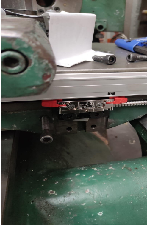
Imagen 2.2.- Instalación mecánica de encoder con nuevos barrenos
