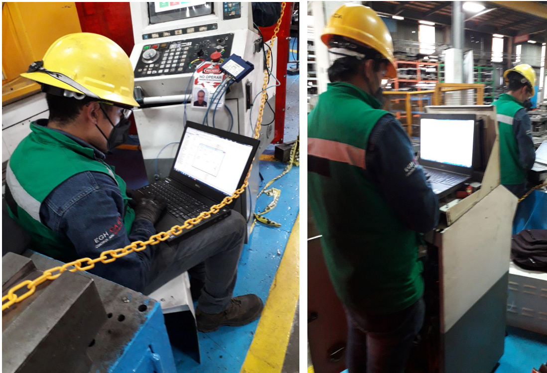
Imagen 2.6.- Programación de PLC y HMI
