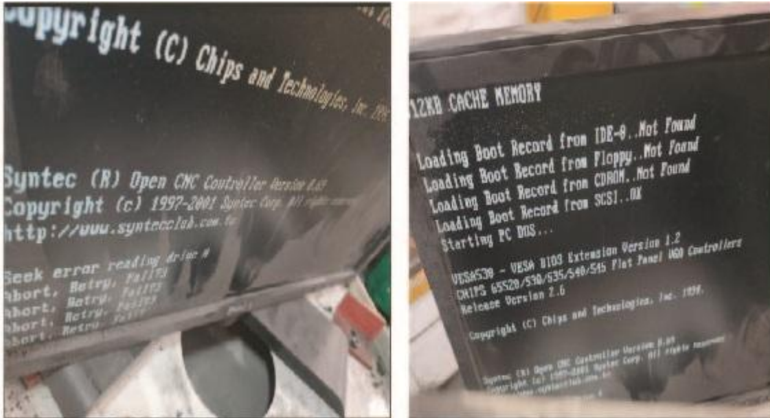
Imagen 2.0.-Falla en tarjeta Bios de CPU
