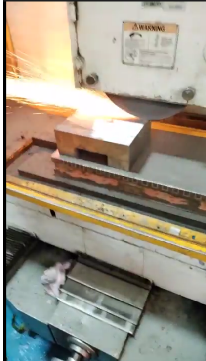
Imagen 2.9.- Rectificado correcto de pieza
