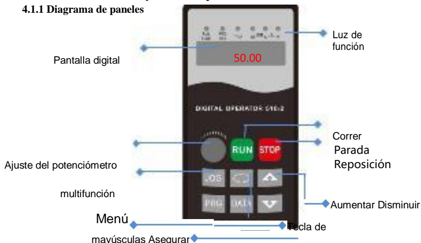
Figura 4-1 Detalles del panel de control
