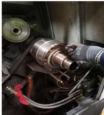
Imagen 2.2.-Desacoplamiento mecánico de flecha
